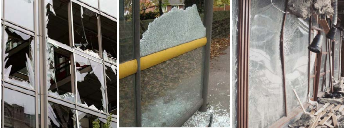
Figuur 13 Verskil tussen ongehard glas (links), gehard glas (midden) en explosiebestendig gelaagd glas met PVB-folie (rechts) (Cormie e.a., 2009; Morris, 2009; Focus Online, 2011)
