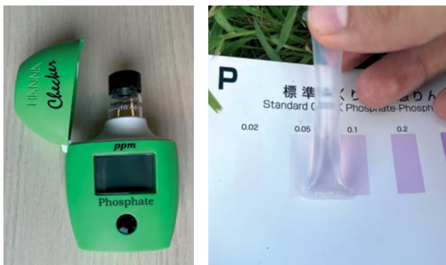
De twee geteste meetmethodes: links de colorimeter van Hanna en rechts de buisjes van Kyoritsu.
